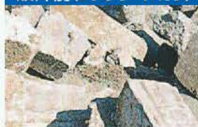
破碎前(コンクリート・ガラ)
