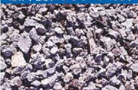
破碎後(コンクリート・ガラ)
