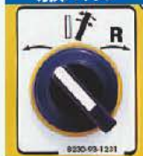
クラッシュャ正転・逆転 切換スイッチ
