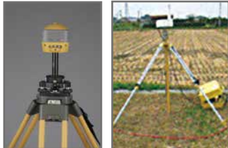
GNSS 固定局/無線送信機
