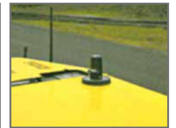
② SS無線アンテナ
