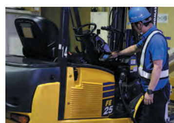
急速充電で稼働率アップ 1時間でバッテリー容量の80%まで充電が可能のため、昼休みに充電すれば一日途切れることなく作業ができる。
