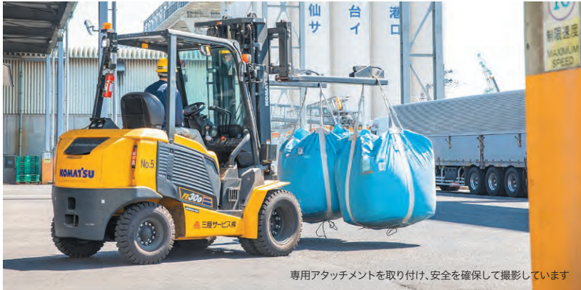
2本のフォークで、合計 1t の荷物を一度に運搬可能
