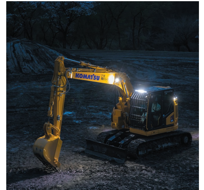
新ライティングシステム 夜間作業時における周囲の視認性を大幅に改善
