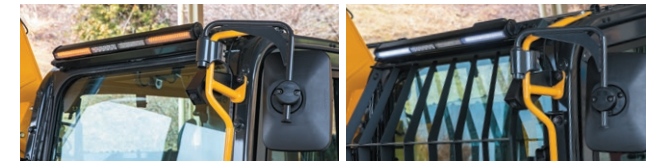
白LEDデイルイト使用時(右) アームクレーンモード使用時(左・オレンジ) 特定の色で点滅し、ステータス(稼働状況)を周囲に示します
