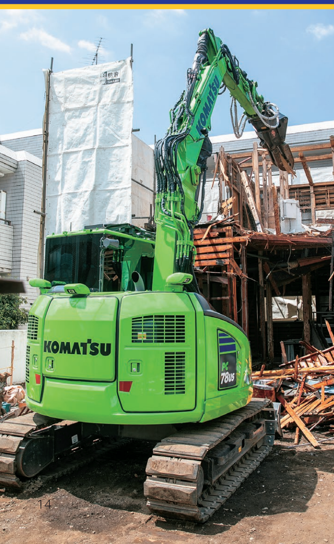
後部の張り出しを抑えたコンパクト設計で、狭い現場でもスムーズに旋回できる
