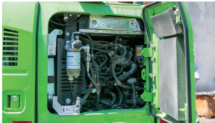
PC78US-11のエンジンルーム。従来の4気筒から3気筒へ刷新し、燃費と静粛性を高めた
