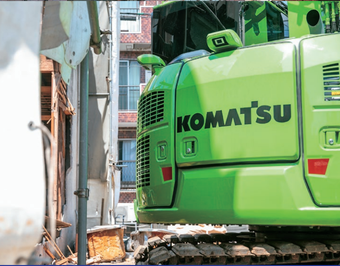
後部の張り出しを抑えたコンパクト設計で、狭い現場でもスムーズに旋回できる
