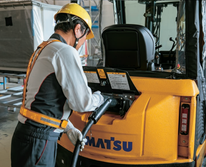
プラグを差し込むだけで簡単に完了するFE25G-2の充電作業
