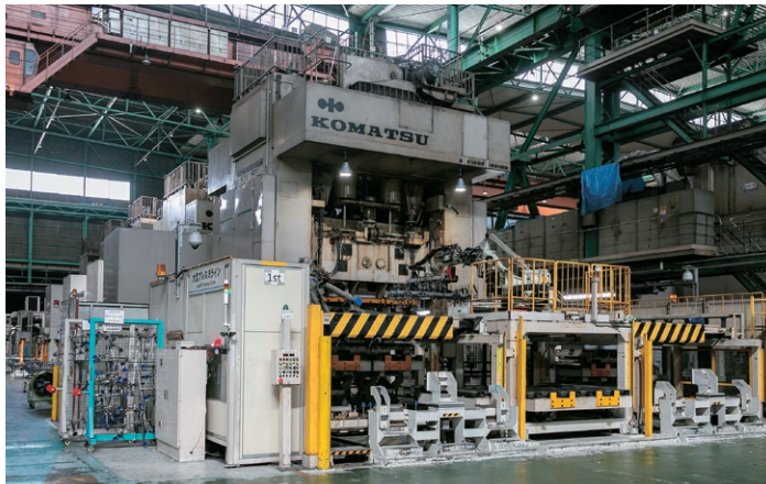
防府工場の生産ラインに設置されたコマツ製の大型プレス機。自動車部品の成形に活用されている
