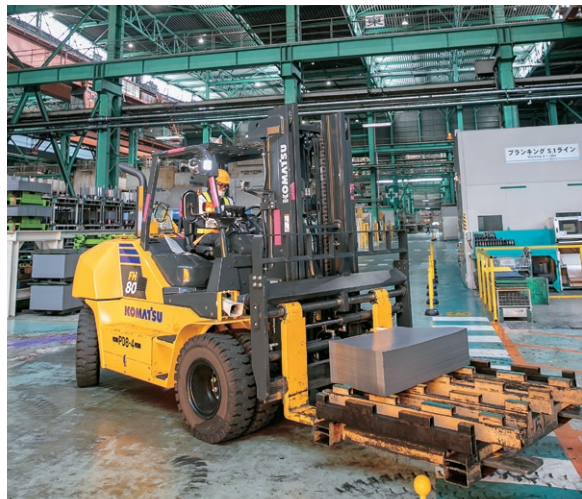
プレス用の材料搬送を担うFH80-2。高出力ながら精密な操作性を備えている
