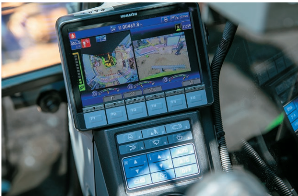
運転席の周囲監視モニター。死角を補い、狭小地でも安心して作業できる
