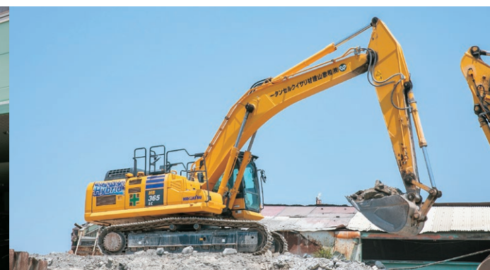
高いエネルギー効率で旋回動作を繰り返すハイブリッド油圧ショベルHB365
