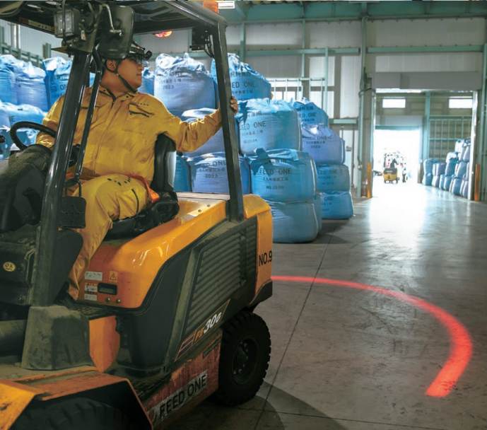
赤いラインでフォークリフトの位置を可視化するアーチライト。 視覚的な注意喚起によって、作業者との接触リスクを低減
