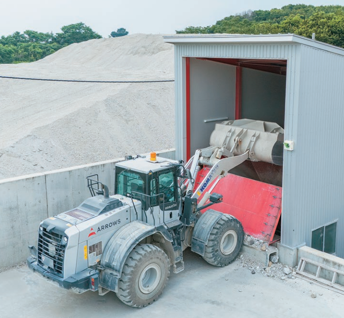
屋内の破碎設備へ廃材を投入するWA380
