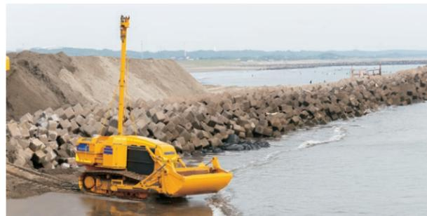
稼働中の水中施工ロボットコンセプトマシン
