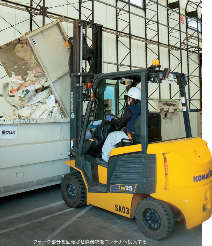
フォーク部分を回転させ廃棄物をコンテナへ投入する
