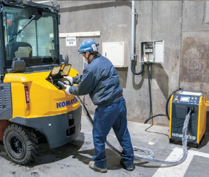
急速充電を行うリチウムイオンバッテリー搭載のFE30G
