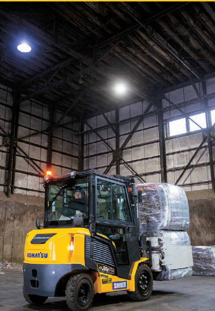
急速充電を行うリチウムイオンバッテリー搭載のFE30G
