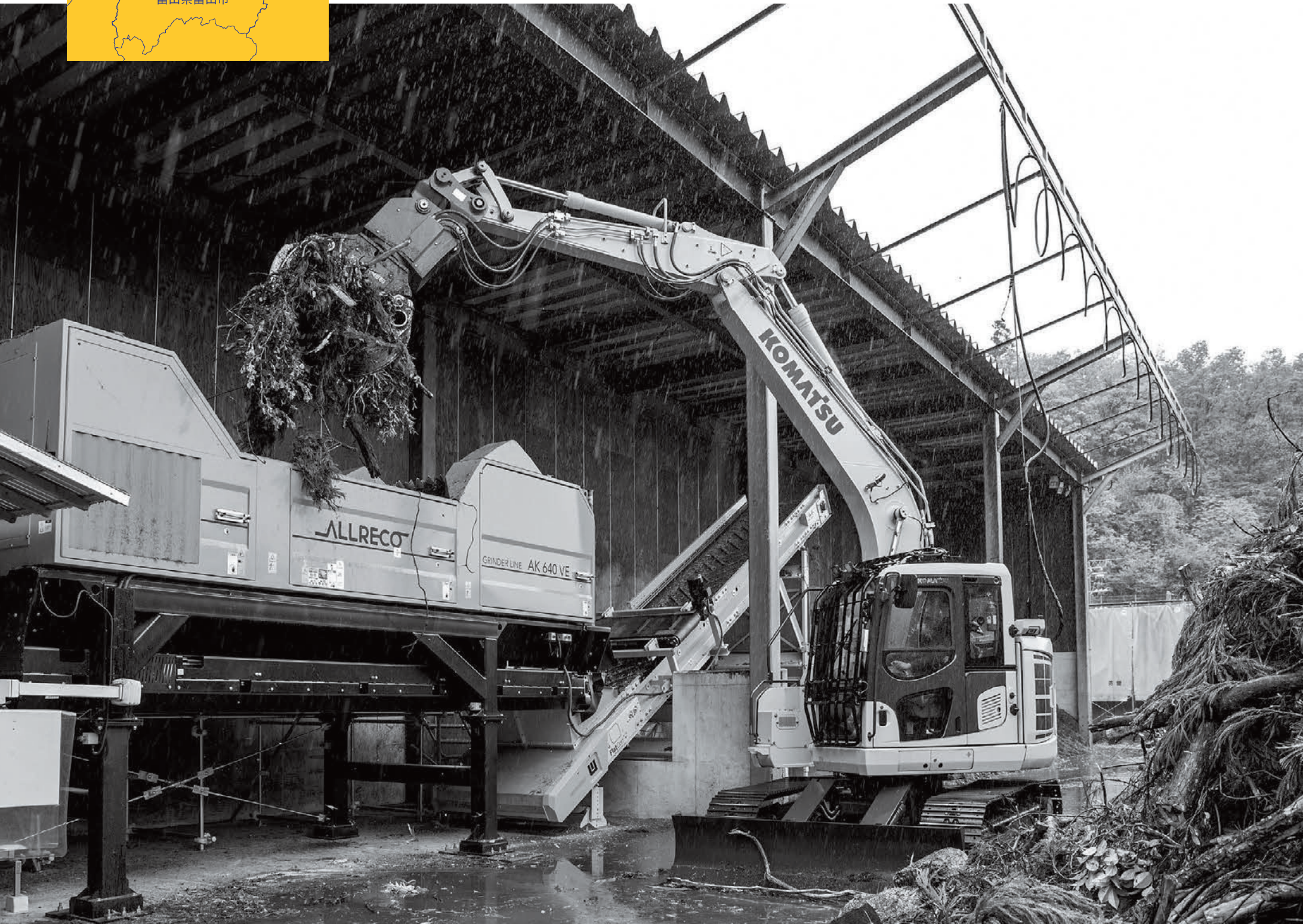
雨などの悪天候でも稼働が可能な有線式電動油圧ショベルを用いた屋外施設
