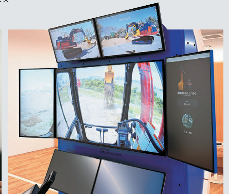
7つのモニターには建機の映像や俯瞰カメラの映像がリアルタイムで送られてくる
