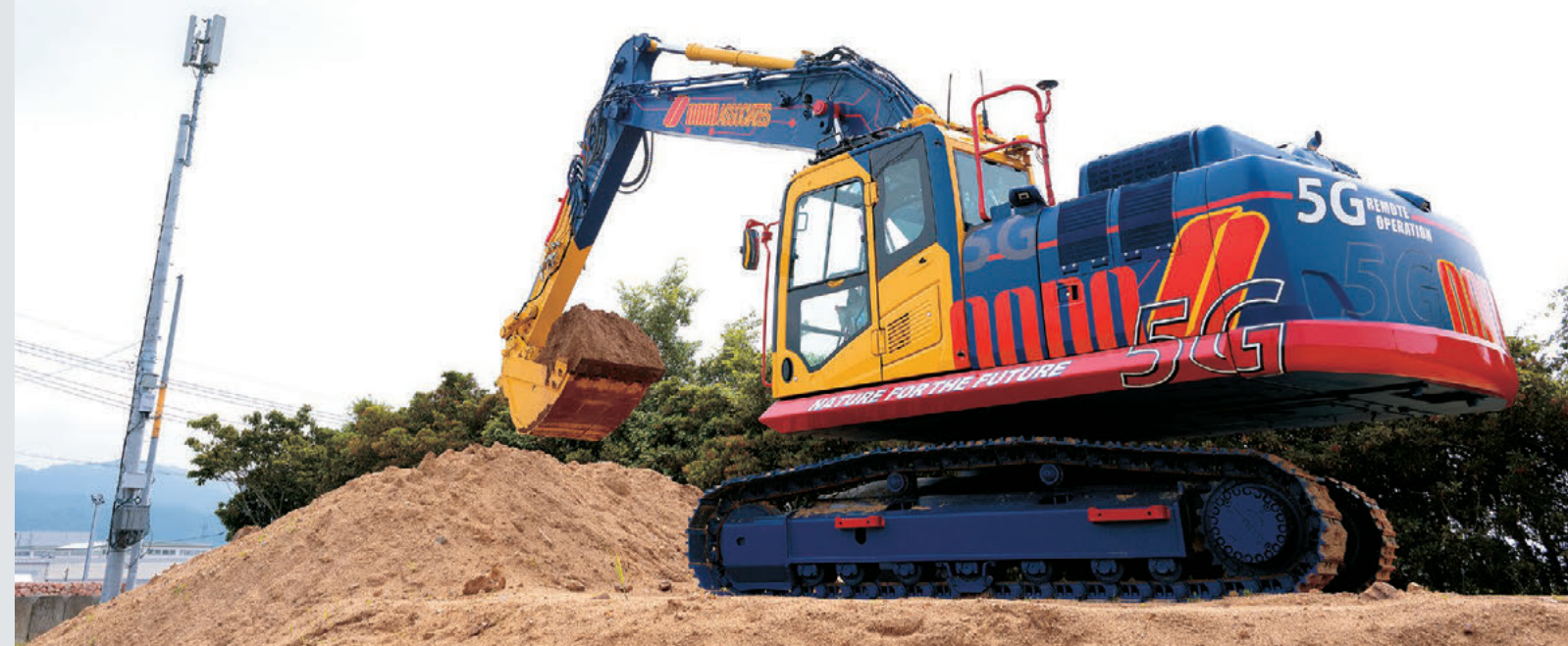
コックピットから送られる信号がラジコン操作に変換され、信頼性の高い無人操作を実現する遠隔建機
