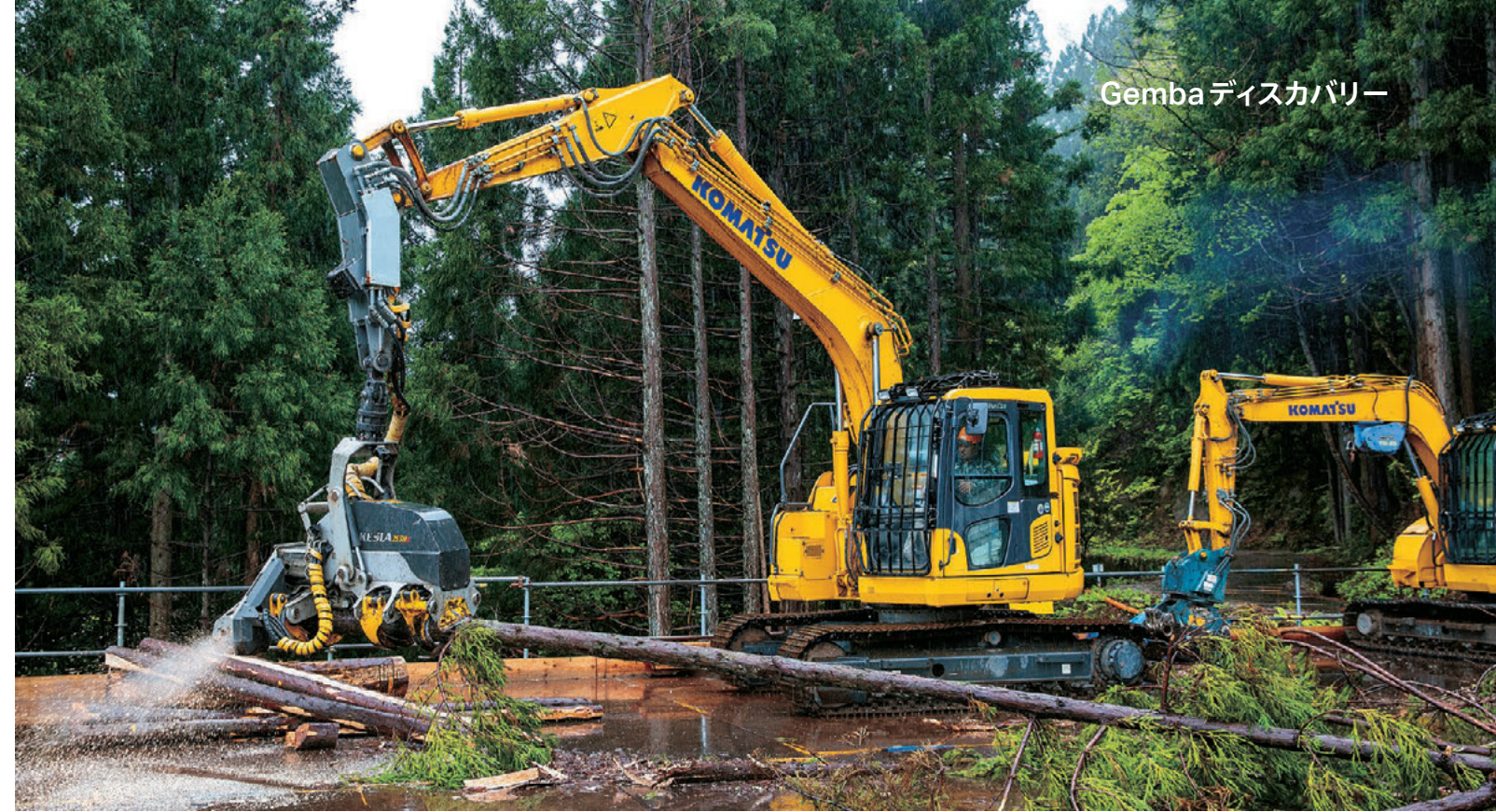
ハーベスターで丸太を切り分ける玉切り作業を行うPC138US-11
