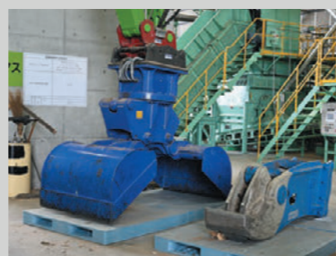
運転席から降りることなくグラブバケットを取り外し
