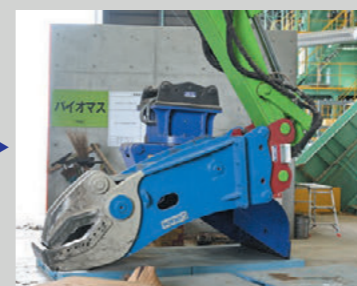
ピン交換も油圧ホースの切り替えもなくアタッチメント交換が完了
