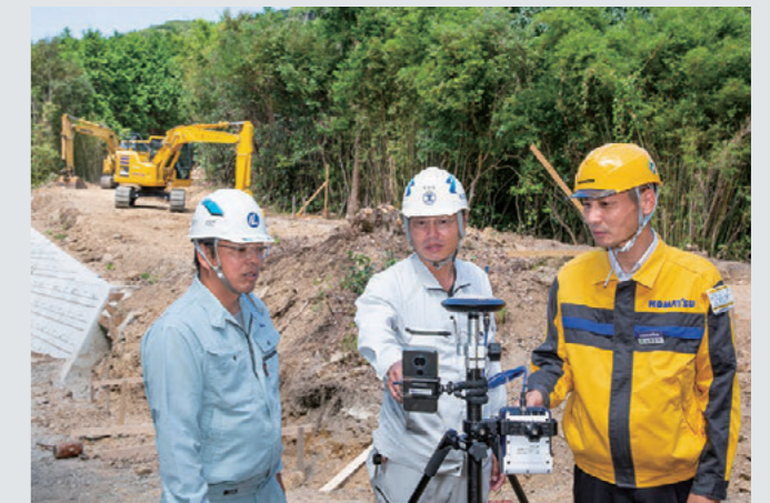
レトロフィットキット装着機とSmart Construction Roverとの連携による、手軽で高精度な土木測量は、業務効率を更に高める
