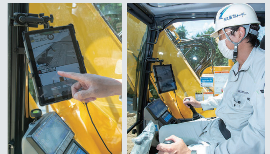
タブレットのモニターにより状況をリアルタイムで確認、正確な作業をスムーズに行う
