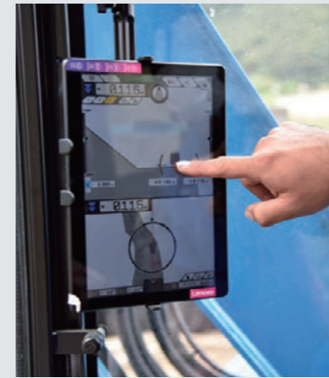
オペレーターはタブレットに表示されるガイダンス画面を確認しながら作業を行う
