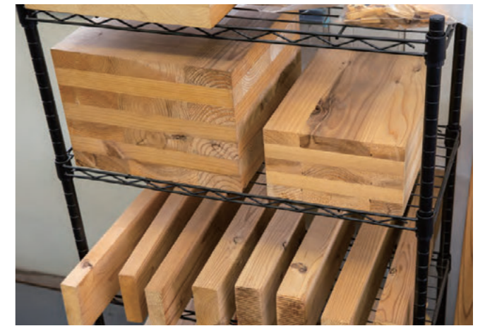
CLT材(写真上)とラミナによってつくられた集成材(写真下)
