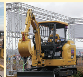
PC30E-5 バッテリー搭載電動ミニショベル
