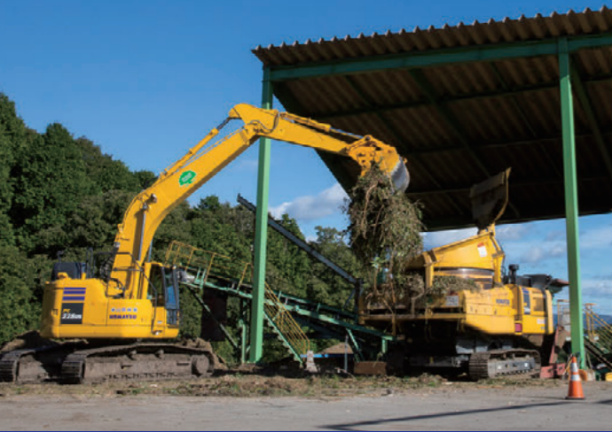
木くずを自走式木材破砕機 BR200T で再利用できるようチップ化する
