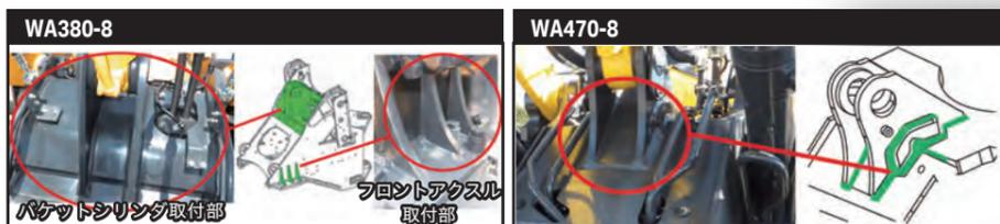
トンネル用強化型フロントフレームを採用。偏った高荷重のかかるサイドダンプバケット作業に最適化しています。
