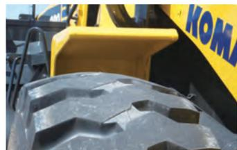
狭所での作業を考慮し、狭幅板金フェンダを採用。フェンダの接触を気にすることなく、作業が行えます。
