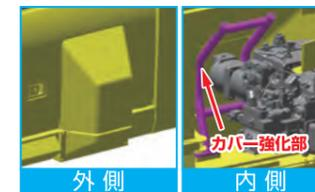
ギアポンプを保護するため、サイドカバーの外側、内側を強化しています。
