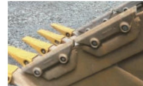
貫入性と耐摩耗性を両立させたツールとベースバケットを保護するガードです。
