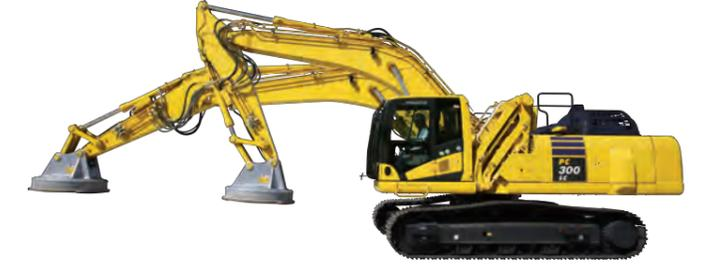
重量物ハンドリング用の油圧調整をさらに進化させ、作業機の起動停止のショックと車体揺れ制御システムを織り込みました。
