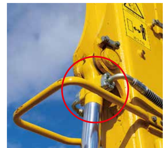
油圧ホース接続部はロッドに接続
