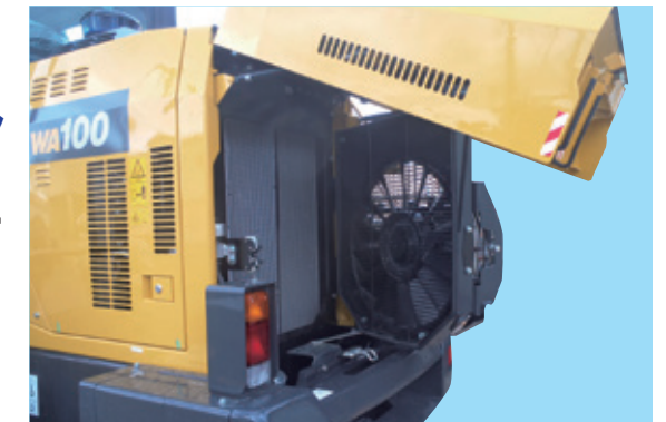
逆転機能付き油圧駆動ファン ラッチ式スイングアウトファン
