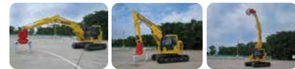
最大作業半径:7890mm 最小作業半径:3150mm 最大作業高さ:9215mm
