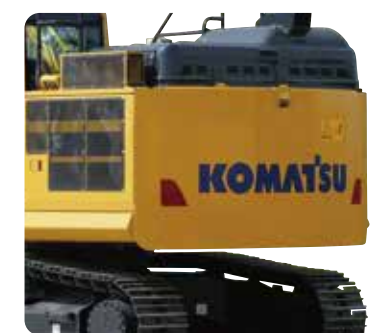
林業仕様専用 カウンターウエイト 後端旋回半径:2345mm (標準機比 ▲200mm)
