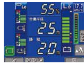
作業半径・揚程・負荷率表示
