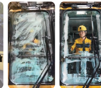
セパレートワイドワイパーの機能、視認性等を確認する試験の様子
