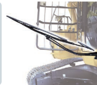
ワイパーブレードを上下2つに分割したセパレートワイドワイパー
