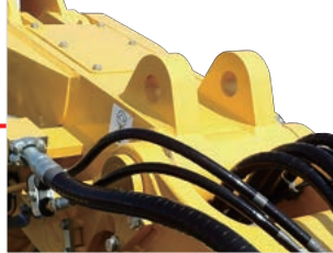
車体丸吊りフック
