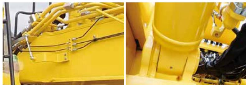
ブームフート部やアーム先端部などにグリス給脂位置を集約、メンテナンス性を向上しました。更に、回転部であるブームシリンダーフートの給脂位置を、従来のピン中心から移動させたことで、作業機姿勢によらず給脂できるよう、標準装備しました。(ロングフロント作業機と2ピースブームでは集約場所が異なります)。
