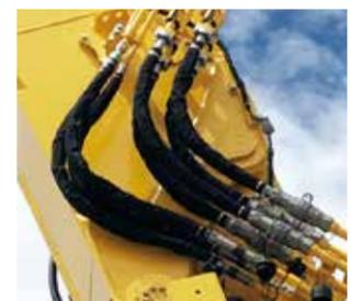
周囲との接触から油圧ホースを保護し、万一作動油が漏れても飛散を防止します。
