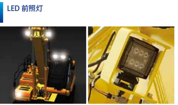
ファーストブーム両側の各1基、キャブ上部に2機、旋回体右前部に1基を配置。計5基のLED前照灯で、暗所での視界性を向上。
