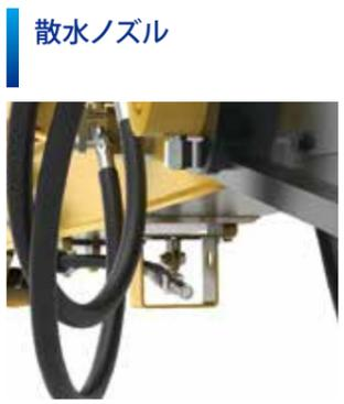
破碎時に出る粉塵の飛散を抑えるため散水ノズル、ホースを標準装備しています。(散水用のポンプ水タンク等は別手配です。散水用のポンプは吐出圧1MPa以下のものをお使いください。)
