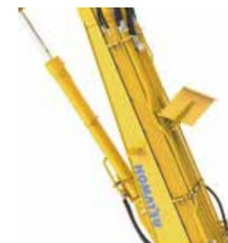
破砕片のキャブへの落下を防止するため、トップブーム上に折り畳みできるガードを装備しました。（解体ロングフロント）
