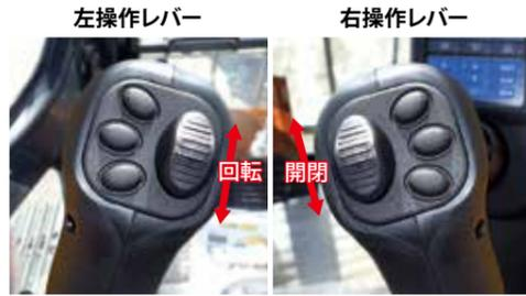
指の操作量によりアタッチメントの旋回・開閉のスピード調整が可能なプロポーショナルスイッチ（比例制御スイッチ）を標準装備。微操作性が向上、位置合わせが容易に行えます。
