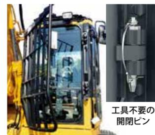
ガラスの衝突を想定して、安全ガラスに加えて運転員保護ガード（フロントガード）を標準装備。JISレベル2 (ISO 10262)、労働安全衛生法の飛来物防護設備に適合。
