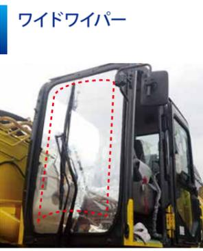
大型ブレードの採用により、上方の拭き取り範囲を大幅に向上させたワイドワイパーを標準装備。
