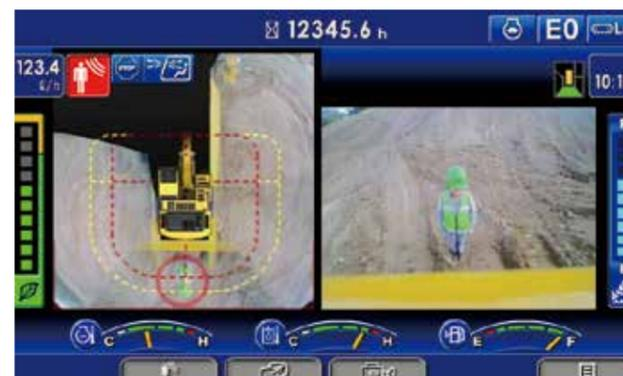
3台のカメラを用いて機械周囲をモニタ上に表示します。人検知衝突警報システムの稼働状態も表示されます。モニタの右側画面は、F4キーで機体の右側方、左側方、後方の画像に切り換えることができます。
