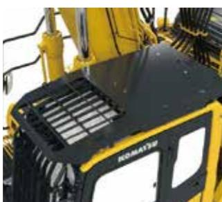
固定式の運転員保護ガード（トップガード）を標準装備。レベル 2 (ISO 10262)、および労働安全衛生法のヘッドガード基準に適合。
