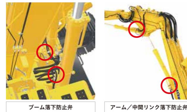
万一油圧ホースが破損したとき、作業機の突然の落下を防止するため作業機シリンダに落下防止弁を標準装備しました。
