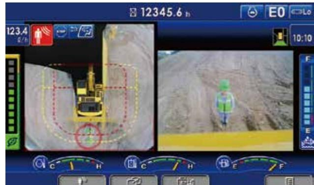
3台のカメラを用いて機械周囲をモニタ上に表示します。人検知衝突警報システムの稼働状態も表示されます。モニタの右側画面は、F4キーで機体の右側方、左側方、後方の画像に切り換えることができます。
