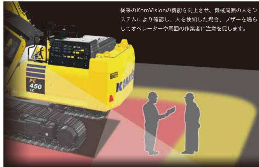
従来のKomVisionの機能を向上させ、機械周囲の人をシステムにより確認し、人を検知した場合、ブザーを鳴らしてオペレーターや周囲の作業者に注意を促します。
