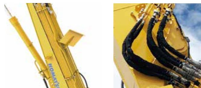
破碎片のキャブへの落下を防止するため、トップブーム上に折り畳みできるガードを装備しました。(解体ロングフロント)
