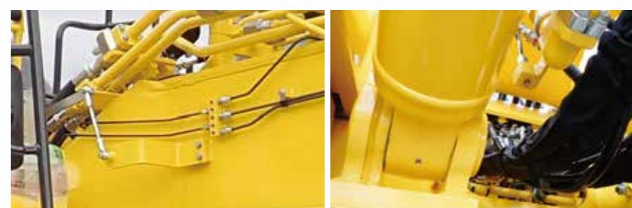
ブームフート部やアーム先端部などにグリス給脂位置を集約、メンテナンス性を向上しました。更に、回転部であるブームシリンダーフートの給脂位置を、従来のピン中心から移動させたことで、作業機姿勢によらず給脂できるよう、標準装備しました。(ロングフロント作業機と 2 ピースブームでは集約場所が異なります)。
