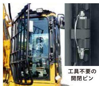
ガラの衝突を想定して、安全ガラスに加えて運転員保護ガード（フロントガード）を標準装備。JIS レベル 2 (ISO 10262)、および労働安全衛生法のヘッドガード基準に適合。
