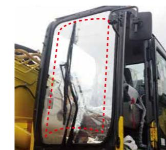
大型ブレードの採用により、上方の拭き取り範囲を大幅に向上させたワイドワイパーを標準装備。
