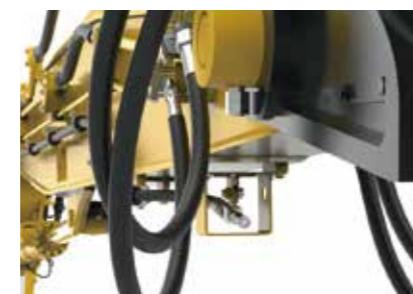
破碎時に出る粉塵の飛散を抑えるため散水ノズル、ホースを標準装備しています。(散水用のポンプ、水タンク等は別手配です。散水用のポンプは吐出圧1MPa以下のものをお使いください。)
