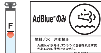
(2) サイトゲージ (3) 安全標識
