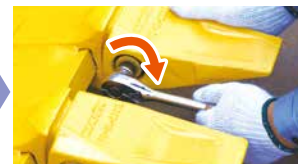
③ 専用ピンにプッシュ、ワッシャ、ボルトをセットし、ラチェットで締付け
