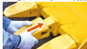
① 既存の横ピン用アダプタに専用ツースをセット
