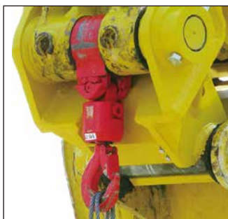
機械式Bロック（干渉防止構造）
