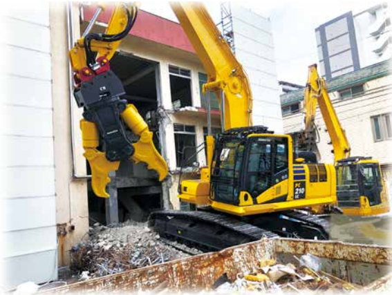
PC210/LC-11 解体SP仕様車 アームクレーン標準装備
