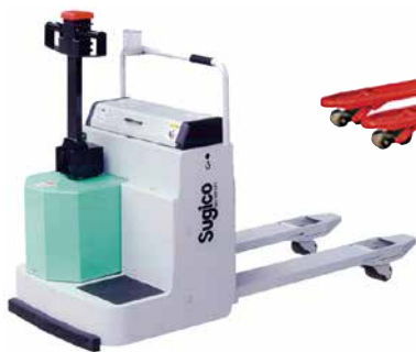
2LW-Rタイプ 杉国工業 ライドオンで移動時の作業性アップ ※写真はオプション装着車(ペン立て)です。
