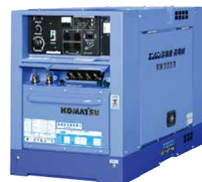
SYKW-KW300D 6 mm棒までの本格溶接に電撃防止機能搭載
