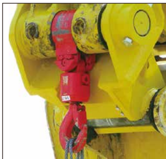
機械式Bロック (干渉防止構造)
