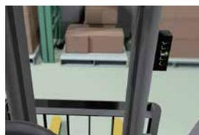
傾き表示のLEDランプは3色。角度0.7°未満の時グリーンランプが点灯し水平を知らせる。アウターマスト取り付けのため視界を邪魔しない。
