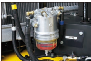
ウォータセパレータ機能付燃料プレフィルタ
