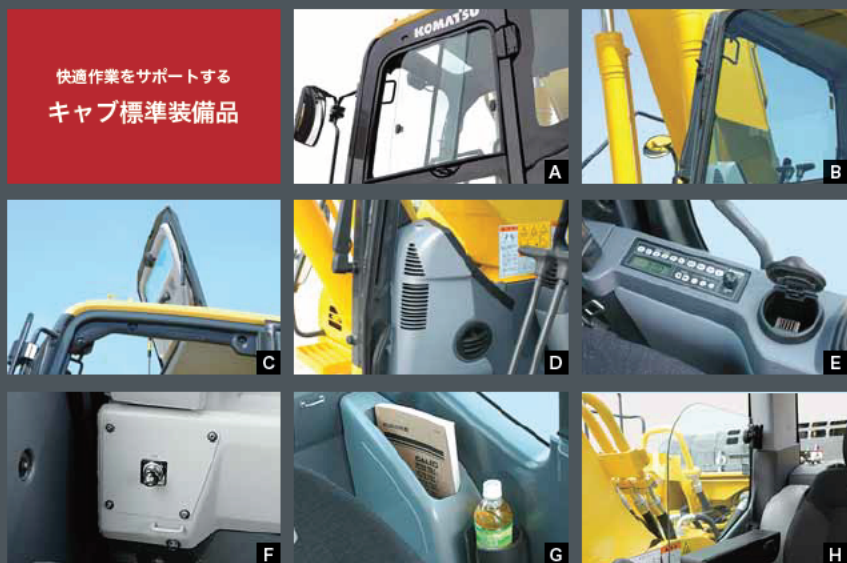
A スライド窓(左サイド) B ウォッシャー付リモート間欠ワイパ C 開閉式天窗 D デフロスタ(ISO 10263-5適合) E AM/FMステレオラジオ、灰皿 F シガレットライター G マガジンラック&カップホルダ H 前窓アークガラス ワンタッチ収納
