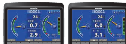
実荷重・定格荷重・負荷率表示
