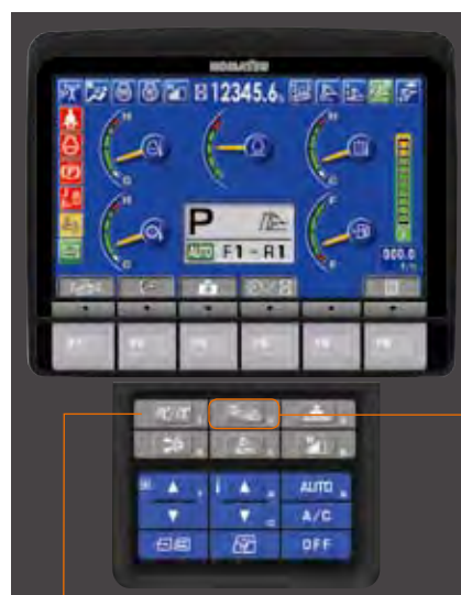
運転モード切り換えスイッチ
