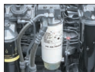
燃料プレフィルタを装備 (ウォーターセパレータ機能付)
