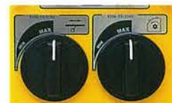
右：クラッシャスピードコントロールダイヤル 左：フィーダスピードコントロールダイヤル
