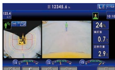
実荷重・定格荷重・負荷率表示
