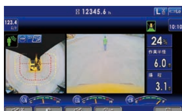
作業半径・揚程・負荷率表示
