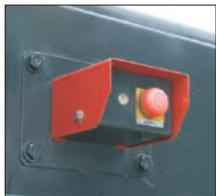
緊急停止スイッチ (エンジン始動ロック機能付)
