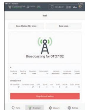
GNSS補正情報の配信状況をタブレットで都度確認することができます。
