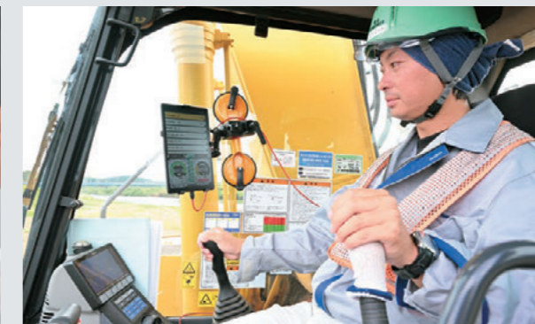
ペイロードメーターを確認し効率的な積み込みを行うオペレーターの伊藤洸貴氏
