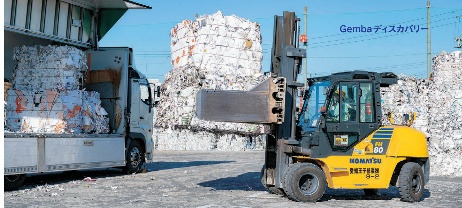
松山氏が操作を行っているFH80。約1tのバールを4つ挟み込んで運搬する
