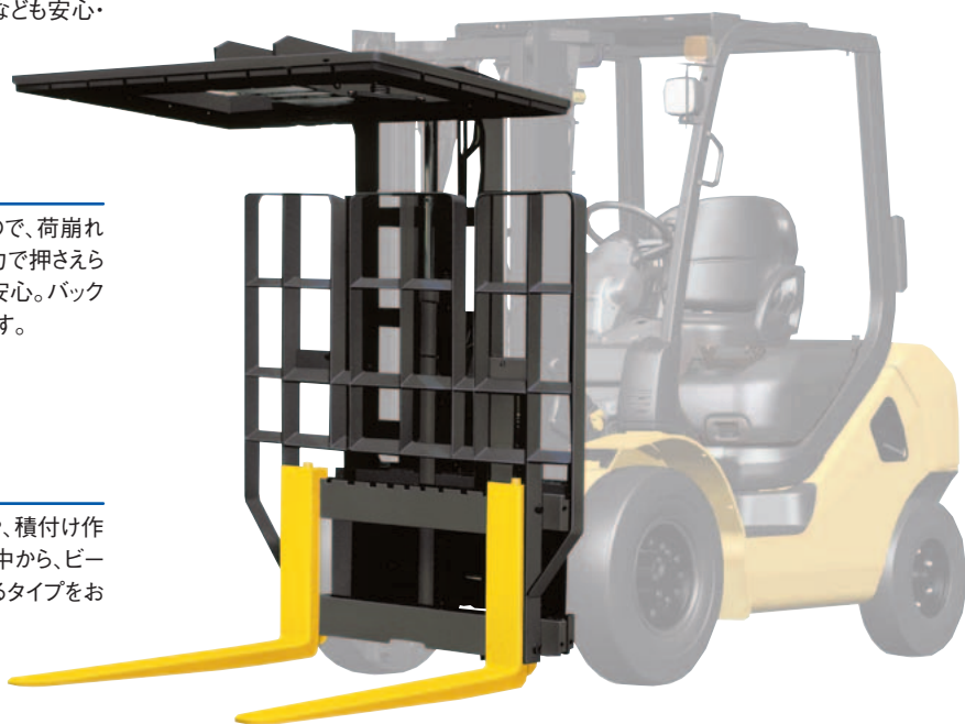
写真はサイドシフト付2ton系コーラタイプスタビライザー（受注対応） スタビライザー部分は、イラストにつき形状及び色調等は実際の車両とは多少異なります。
